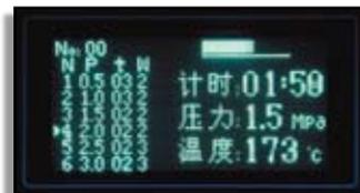
内置三种控制模式（温度主控，压力主控和微波萃取）和30多种样品处理方法，用户可以自行编辑、存储、修改和删除特定样品的应用方法及各项控制参数（包括温度、压力、时间、工步和功率变化范围等等）；反应过程中荧光屏幕可切换显示各项参数变化情况和温度、压力的上升曲线。
