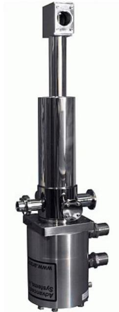
ADVANCED RESEARCH SYSTEMS (ARS) 公司的 X-12 系列闭循环低温恒温器专为霍尔，磁性，磁光，光电测试设计。独特的窄窗设计使得该款恒温器同样适用于电磁和磁性测试。
