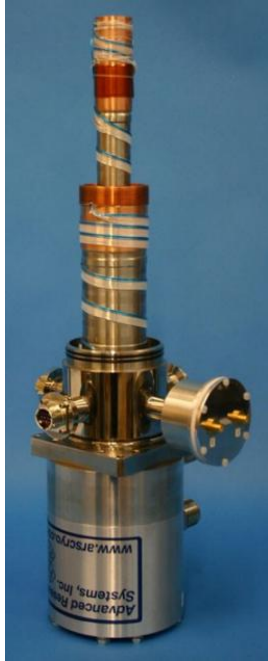
上图为不带真空罩和防热辐射屏的低温恒温器。图中有 2 个 SMA 接头。这是升级了的仪表裙。
