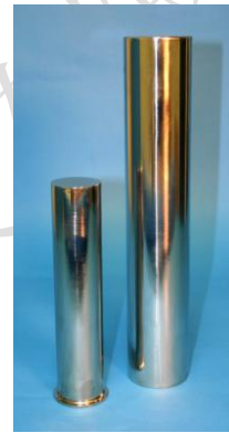
上图是低温恒温器的真空罩和防热辐射屏。
